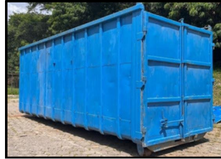
Imagem 14 Caçamba roll on para transbordo de recicláveis da terceirizada - PUSP CB
