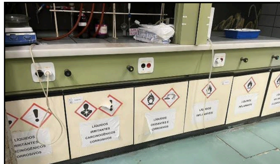
Imagem 59 Armários identificados com o tipo risco proveniente de material que é armazenado
