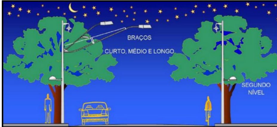
Figura 07. Propostas de iluminação para vias com intensa arborização. (Fonte: Finocchio, 2014).
