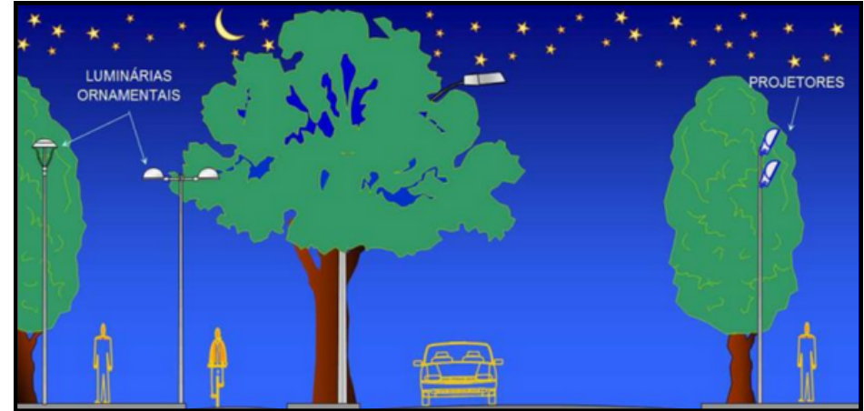
Figura 09. Propostas para projetos específicos de iluminação pública para passeios em áreas com intensa arborização (Fonte: Finocchio, 2014).
